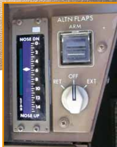
Ein Blick auf die zur Trimmung notwendigen Kontroll- und Eingabeinstrumente im Cockpit einer Boeing.
