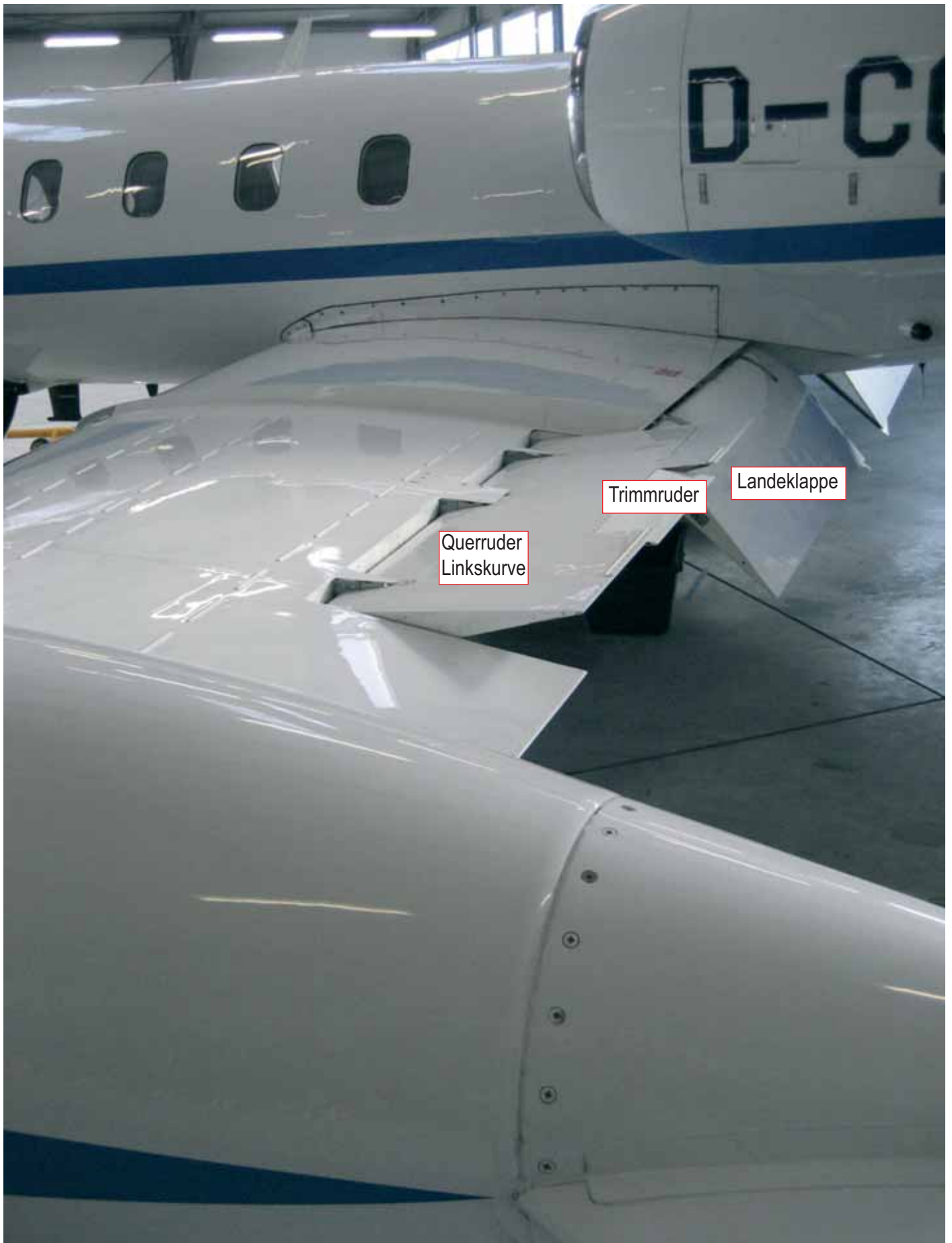
Steuerflächen, wie sie bei jedem Flug zum Einsatz kommen können
