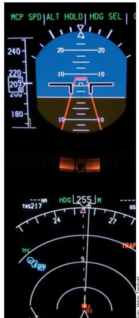
Eine unmittelbare Bedrohung durch anderen Verkehr wird dem Piloten in Rot angezeigt, zudem zeigt der künstliche Horizont ein Ausweichkommando an.
