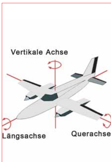
Die Achsen eines Flugzeuges
